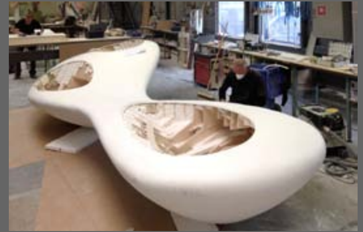
Basisvorm in schuim wordt gemaakt waarop later Corian wordt aangebracht. Ontwerp 3TO i.s.m. Ingrid Annokkee.
